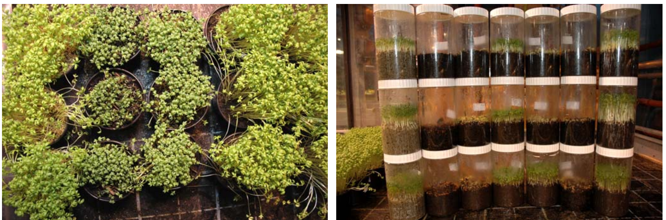
Foto 4 > Analyse der Phytotoxizität mit dem offenen Kressetest (links) und dem geschlossenen Kressetest (rechts)
