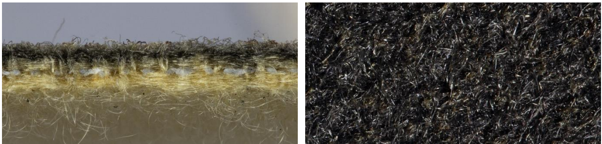
Abbildung 57: links Querschnitt des Filters; rechts: Staubseite
