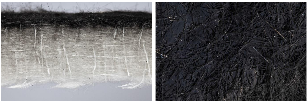
Abbildung 30: links: Querschnitt durch den Werkstoff; rechts Staubseite
