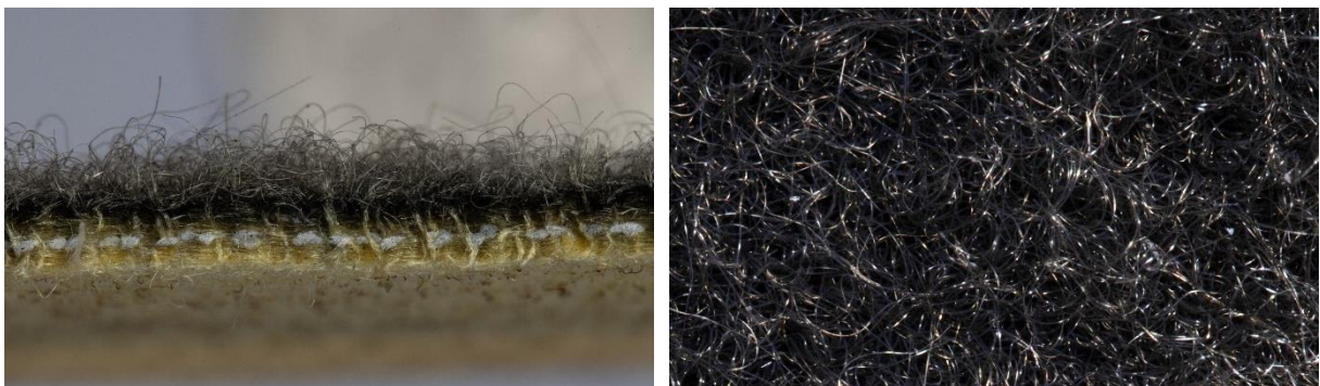
Abbildung 36: links: Querschnitt durch den Werkstoff; rechts Staubseite
