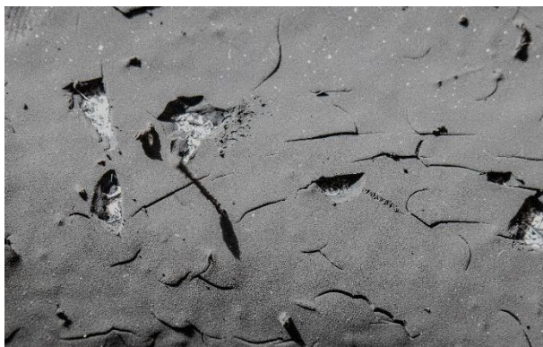
Abbildung 62: Staubkuchen nach dem Abscheiden mittels Rüttler
