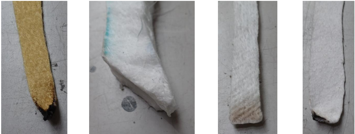
Abbildung 15: Ergebnisse der Versuche auf Brennbarkeit der Materialien microvel® PL, Herding Glasfasermatte, isoGLAS® Nadelvlies 500g/m 2 und needlona® (von links)
