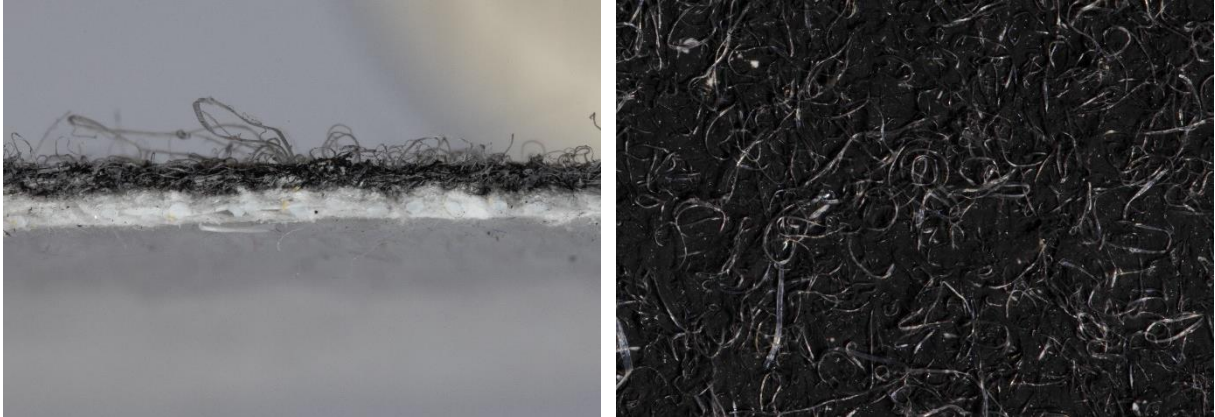
Abbildung 32: links: Querschnitt durch den Werkstoff; rechts Staubseite
