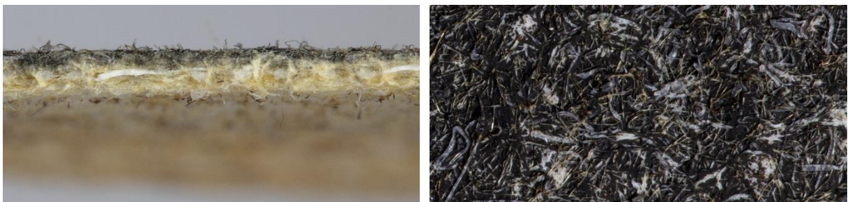
Abbildung 34: links: Querschnitt durch den Werkstoff; rechts Staubseite
