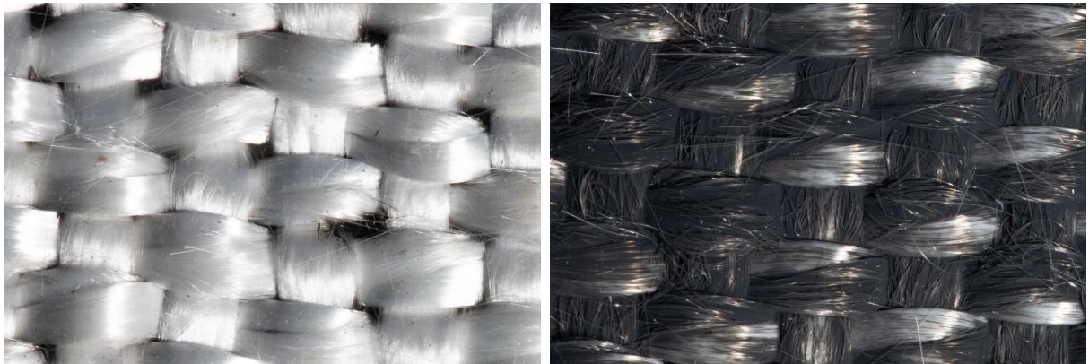
Abbildung 28: link: Reingasseite; rechts: Staubseite
