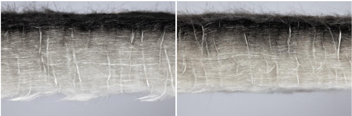
Abbildung 51: Vergleich Filterquerschnitt; Anströmgeschwindigkeit links 1.2 m/min, rechts 6 m/min
