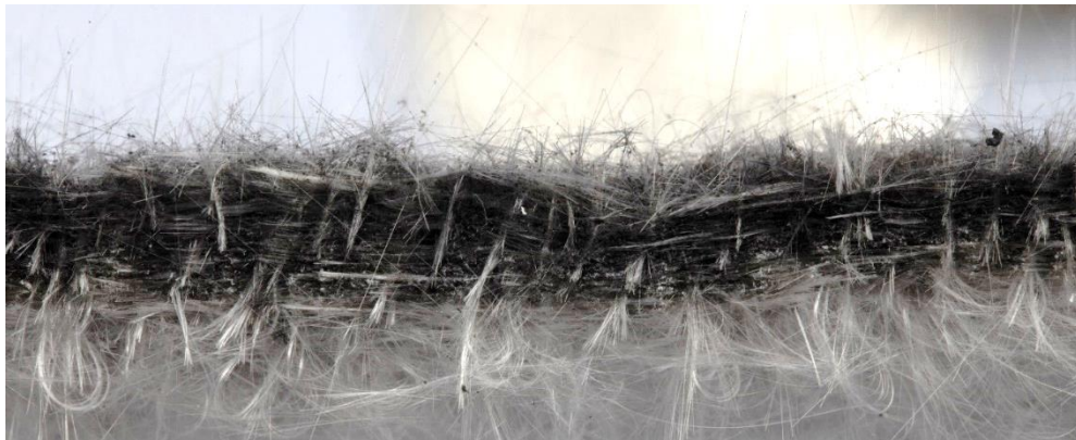
Abbildung 59: Querschnitt durch das isoGlas® Nadelvlies 500 g/m 2 nach einer Belastung mit 6 m/min
