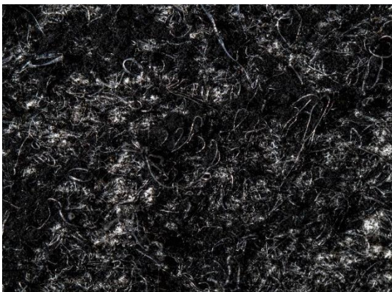
Abbildung 64: Staubkuchen bzw. Staubseite nach dem Abstreifversuch
