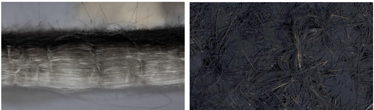
Abbildung 40: links: Querschnitt durch das Material; rechts Staubseite
