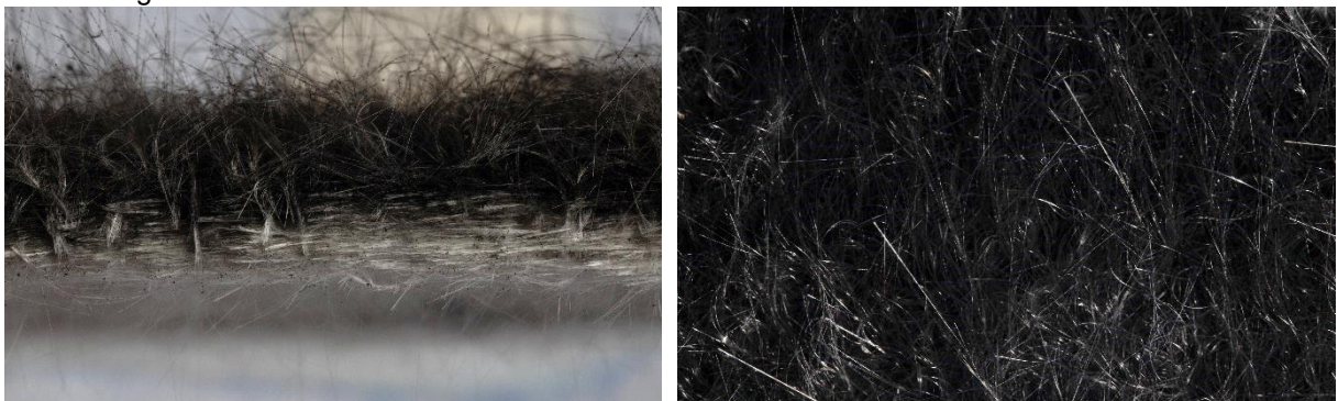
Abbildung 38: links: Querschnitt durch das Material; rechts Staubseite
