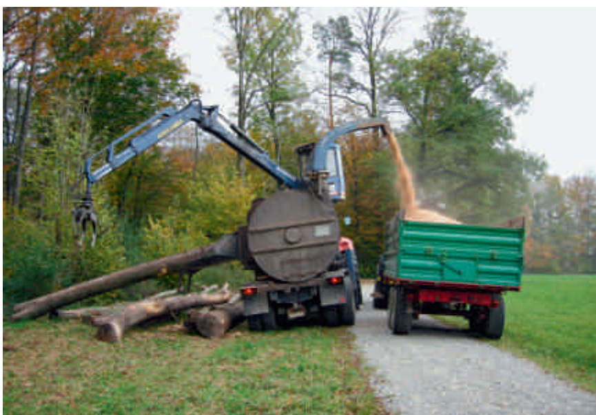
Abb. 6: Ein Grosshacker mit Kran erleichtert nicht nur die Arbeit, im überbetrieblichen Einsatz ist er auch kostengünstiger als die zapfwellenbetriebenen Anbau- oder Anhängerhacker.
