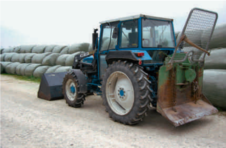
Abb. 4: Durch den Einsatz von Frontlader und Seilwinde kann die Arbeitsbelastung stark reduziert werden. Doch die hohen Maschinenkosten führen dazu, dass dieses Verfahren insgesamt die höchsten Kosten hat.
