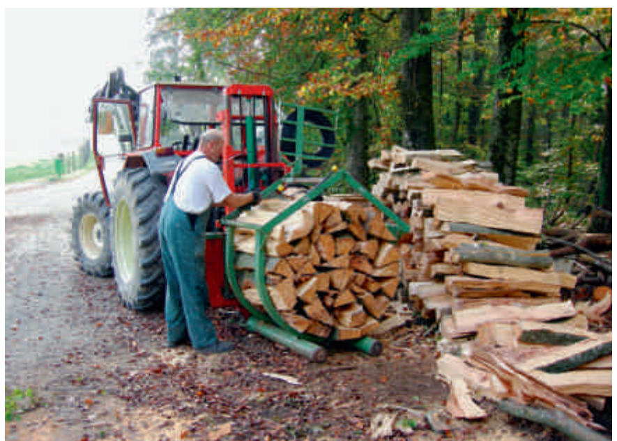
Abb. 5: Durch das Bündeln der Meterscheite kann der Arbeitsbedarf und die Arbeitsbelastung gesenkt werden.
