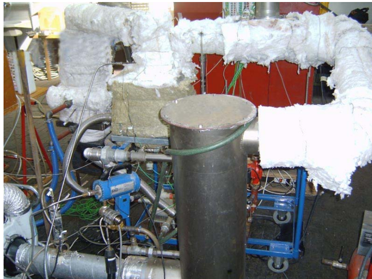
Abbildung 4 Aktuellste Variante des Funktionsmusters im verbrennungstechnischen Labor des Ökozentrums Langenbruck. Von hinten links der isolierten Abgasleitung folgend nach unten links: Brenner, 1. Analyse-Sonde, Quench, Hochspannungs-Elektrode, Absetzstrecke, Abgaskondensator, 2. Analyse-Sonde, Abgasventilator.
