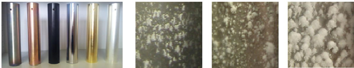
Abbildung 4: Wärmetauscher von links nach rechts Glasnanopartikel auf Edelstahl und Kupfer, Teflon, Edelstahl elektropoliert, Gold, Silber und Trockeneisbildung in Abhängigkeit der Strömungsgeschwindigkeit auf Edelstahl
