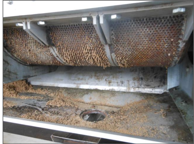
Abbildung 1: Ansicht der Presse auf der Sekundärseite. Es ist in Ansätzen erkennbar, dass das Pressgut ‚Biertreber‘ das Sieb verstopft.
