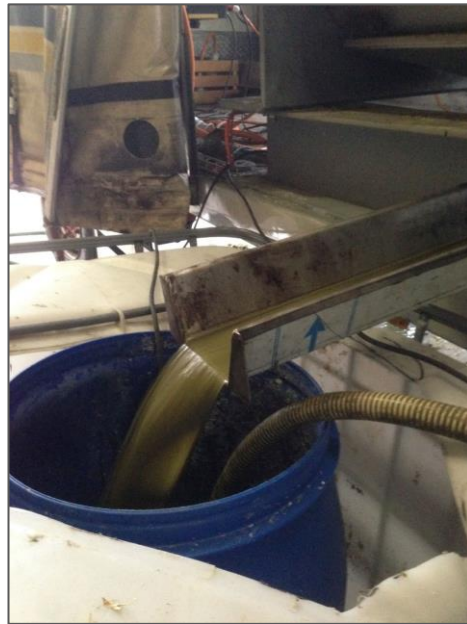
Abbildung 5: Das anfallende grüne Presswasser wird mit einem Behälter aufgefangen als Volumen gemessen.
