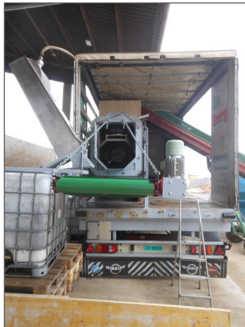
Abbildung 6: Impression Versuchsaufbau mit Ansicht der geöffneten Presskammer.
