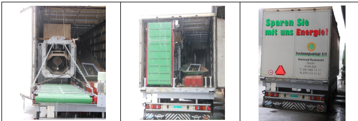
Abbildung 1 a,b,c: Fotografische Dokumentation der montierten Presse auf dem mobilen Hänger mit abgelassenem Zuführband (a), aufgeklapptem Zuführband (b) und geschlossenem Hänger (c)
