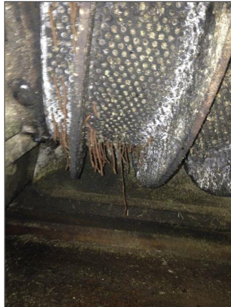
Abbildung 4: Beim Versuch mit Apfeltrester wird das Sieb vollständig durch das Pressgut verstopft.
