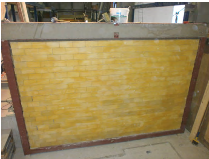
Abbildung 8 Stahl-Wechselrahmen mit Mauerwerk (Kalksandstein)
