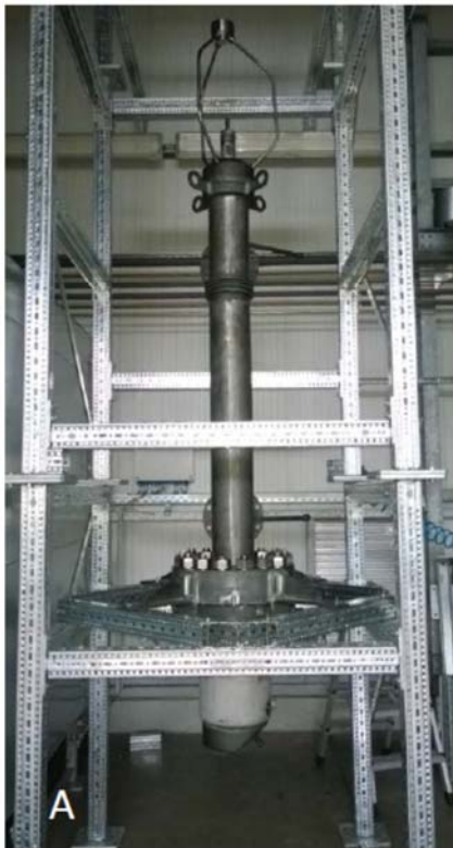
Abbildung 3: Installation neuer Apparate in der Pilotanlage VERENA für das EtaMax-Projekt. A) Salzabscheider, B) Heizsystem.
